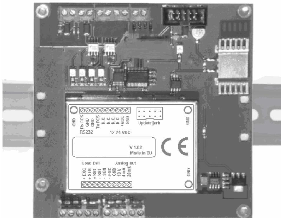
Schéma : Transmetteur analogique R1101 programmable monté sur rail DIN
