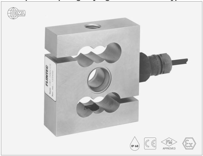
Le capteur de pesage UB1 est disponible pour des charges nominales de 10 kN jusqu'à 50 kN (1020 kg à 5099 kg) et dans les classes de précision GP (C.I.), C1 et C3. La version C3 correspond aux exigences OIML R60 classe III jusqu'à une résolution approuvée de 3.000 pas (graduation)
