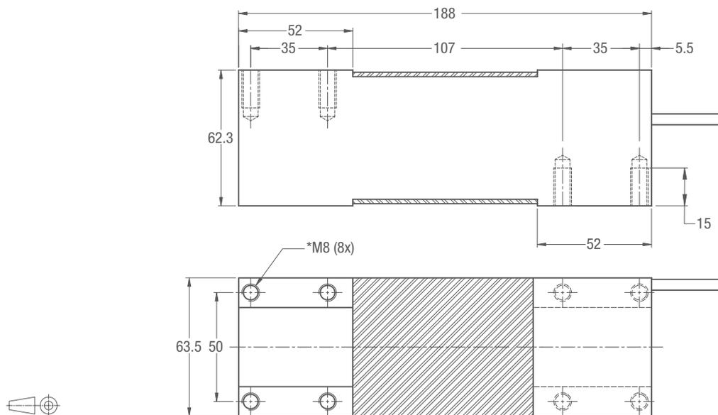
Vis de montage M8 8.8; Moment de serrage 25 Nm. Graisser les filetages avant montage.
